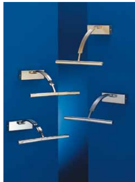
Bilderleuchte AIDA mit eingebautem ET-Trafo Breite 29cm, Auslage 34.5cm Arm in der Höhe verstellbar - Reflektoren um 360° drehbar inklusive 2 x 20Watt G4 12V
