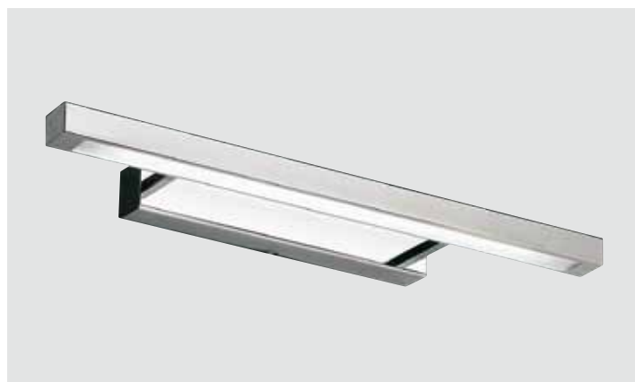
Bilder- und Wandleuchte SOLO mit eingebautem EVG für T5 Leuchtstoffröhren, Reflektor 26 x 26mm und 90° nach unten schwenkbar, Auslage 16.6cm
